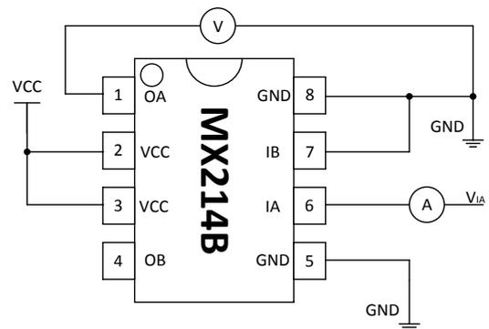
测试图 2 (输入电流 I<sub>IN</sub>)
