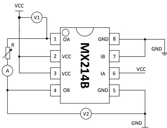
测试图 3 (输出饱和压降 V<sub>O(sat)</sub>=V1+V2)
