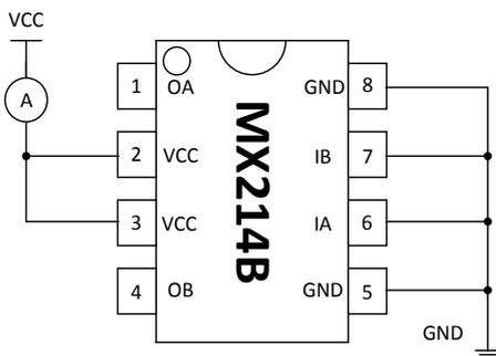
测试图 1 (静态电流 I<sub>DD</sub>)
