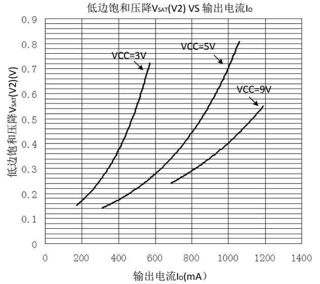
图 5 低边饱和和压降—输出电流
